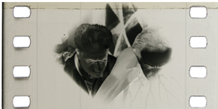
Lichtblitze: Einzelbild Kameranegativ mit einbelichteten Funken aus statischer Aufladung
