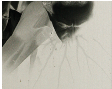
Lichtblitze: Einzelbild Kameranegativ mit einbelichteten Funken aus statischer Aufladung
